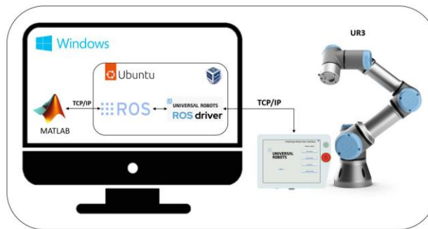
Figura 2. Arquitectura de comunicación entre MATLAB y el UR3.
