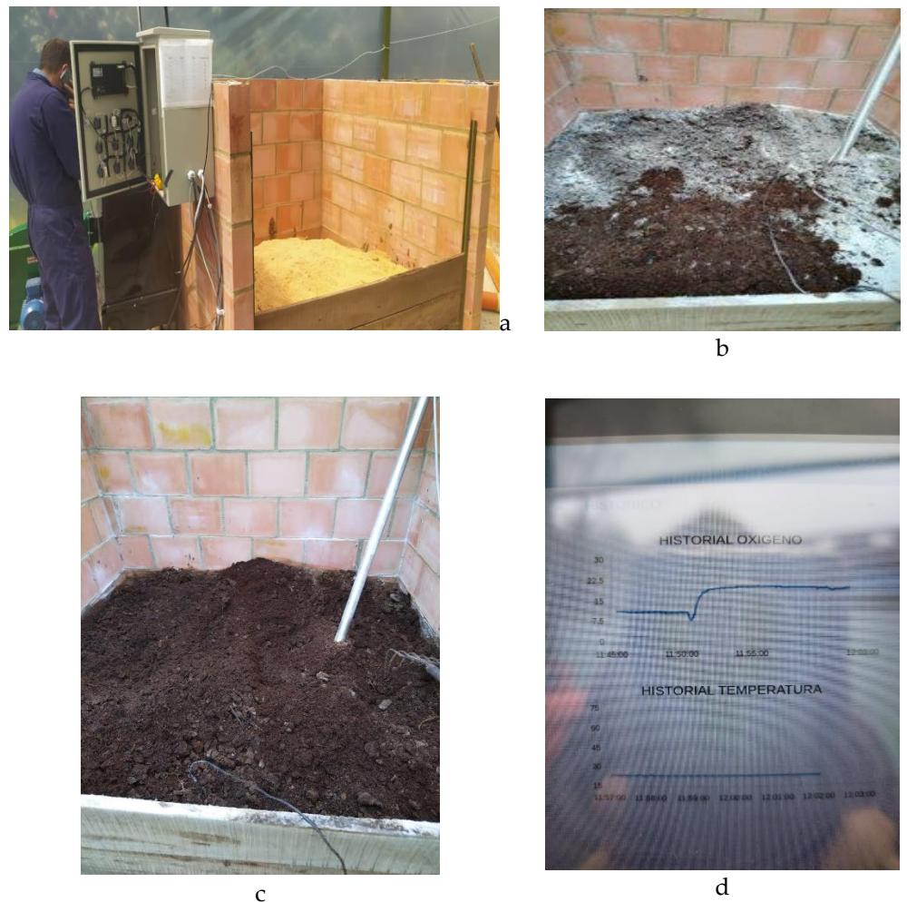
Figura 4. Figura 4. Planta de tratamiento de compostaje. (a) Sistema de control y cama de compostaje 1. (b) Cama de compostaje con adición de cal. (c) Cama de compostaje con producto termino Bioabono. (d) Pantalla en sitio curva del comportamiento de oxígeno y la temperatura de la biomasa
