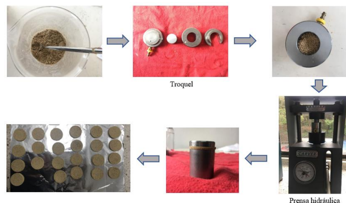
Figura 1. Proceso de compactación de las pastillas. Fuente autor.
