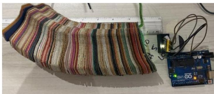
Figura 6. Caracterización de colores en telas con el sensor TCS3200.
