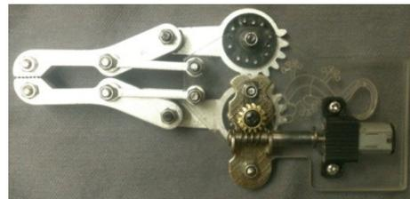
Figura 28 Modificación pinza robótica
