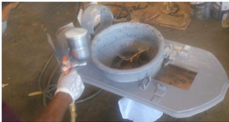
Figura 31. Aplicación de base anticorrosiva
