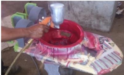
Figura 32. Aplicación de las capas de pintura
