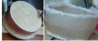
Figura 19. Fase de secado fibra de vidrio
