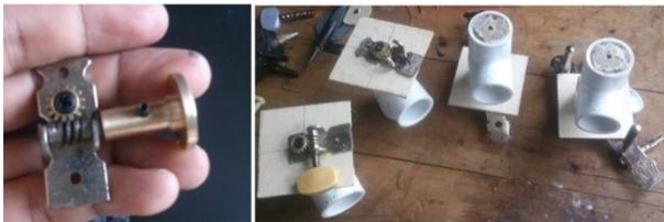
Figura 25. Unión de tornillo sinfín y "T" de PVC
