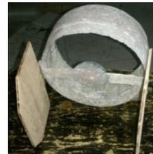
Figura 21. Tobera de propulsión con timón de orientación
