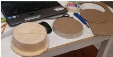
Figura 18. Moldes toberas de suspensión y propulsión
