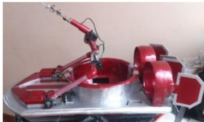
Figura 33. Ensamble final de la base del vehículo sistema de suspensión, propulsión y brazo mecánico
