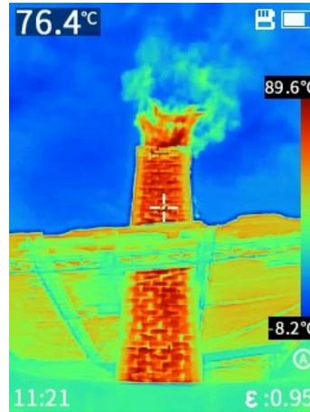
Figura 1. Determinación de calor perdido en chimenea.
