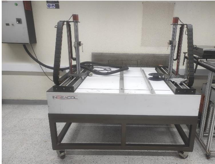
**Figura 1.** Cortadora CNC para Poliestireno expandido.
