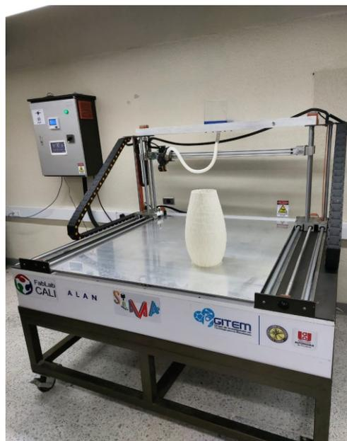
Figura 8. Plataforma de impresión 3D de gran formato.
