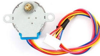
Figura 2. Motor paso a paso 28BYJ-48. Fuente (TECMikro Ecuador, 2023)
