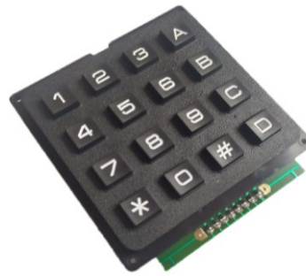
Figura 4. Teclado matricial 4x4. Fuente (Teslab, 2023)
