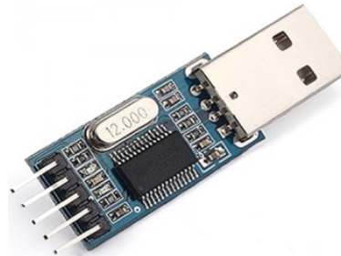
Figura 3. Adaptador USB a TTL RS232. Fuente (www.electronicaplugandplay, 2023)
