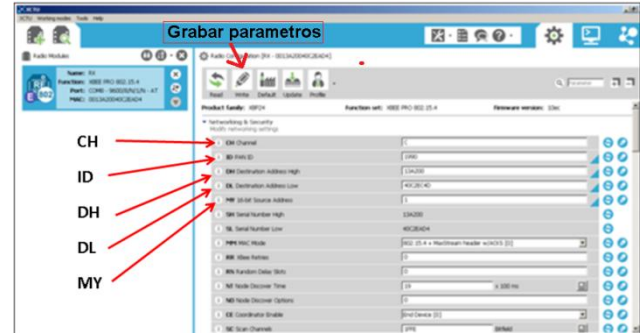
Figura. 7 Configuración CH, PAN ID, DH, DL, MY
