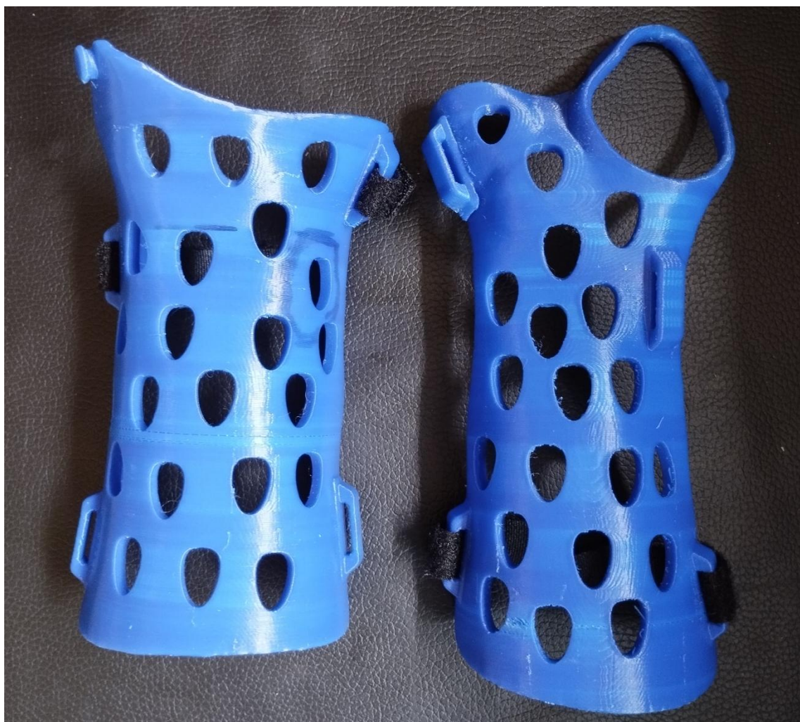
Fig.20 Férula impresa para el tratamiento de la Fractura de Colles. Fuente: Elaboración propia.
