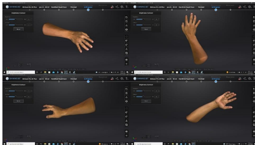
Fig.2. Miembro superior escaneado en posición de seguridad orientada por fisioterapeuta y listo para pasarlo a software de diseño de órtesis y férulas. Fuente: Elaboración propia.
