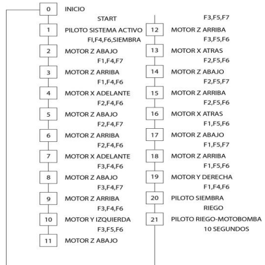
Figura 6. Grafcet del proceso de siembra. Fuente: Propia
