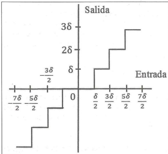
Asumiendo que la entrada del cuantizador tiene una escala apropiada, tal que se encuentra en el intervalo  $(-1,+1)$ , con B bits, el paso del cuantizador es  $\delta=2^{-B}$ , y el error de cuantización resultante de la representación de la entrada analógica de datos tiene la varianza  $\sigma^2=2^{-2B}/12$ .
