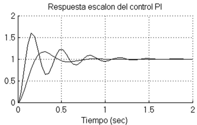
Figura 18. Respuesta del sistema de control PI
