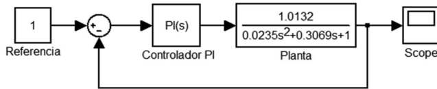
Figura 12. Diagrama de bloques de sistema de control de velocidad.
