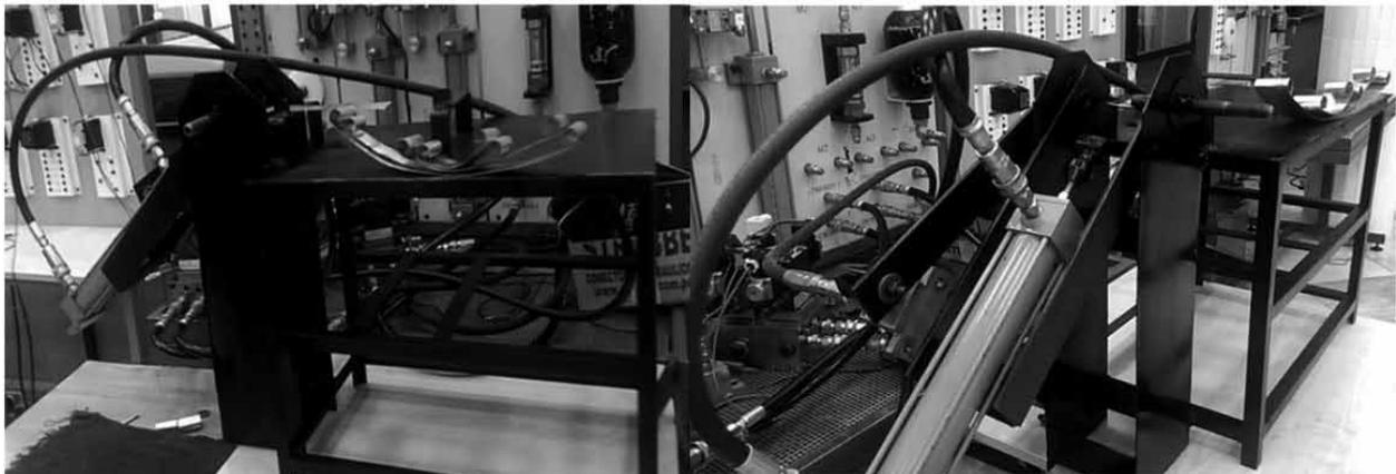
Figura 16. Prototipo de máquina para conformar ojos u orejas de ballestas.
