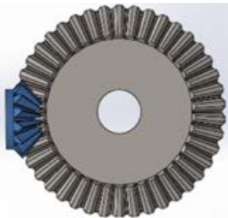
Fig. 3 Engranes cónicos entre ejes de 90 grados
