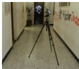
Figura 7. Fachada interna (pasillo) a uno de los costados del aula C220 y posicionamiento del sonómetro al momento de medir el aislamiento acústico de la fachada esta sala.
